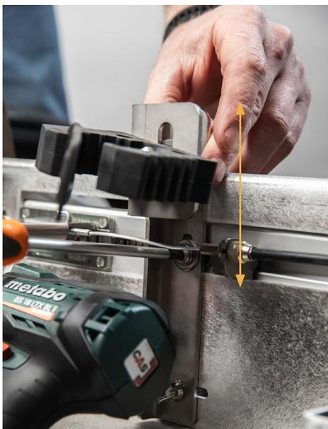
4. Die Höhe der Gummi-Klemme kann simpel adjustiert werden, indem die Klemme verschoben wird.
