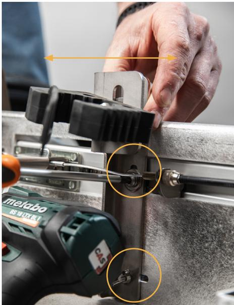
3. Stellen Sie die Position der Gummi-Klemme ein, mit der der Akkuschauber-Schaft befestigt wird. Für die seitliche Verstellung muss dafür die TORX Schraube (TX30) gelockert werden, öffnen Sie außerdem an der Rückseite die untere Schraube mit einem 8er Schraubenschlüssel oder einer 8er Nuss.
