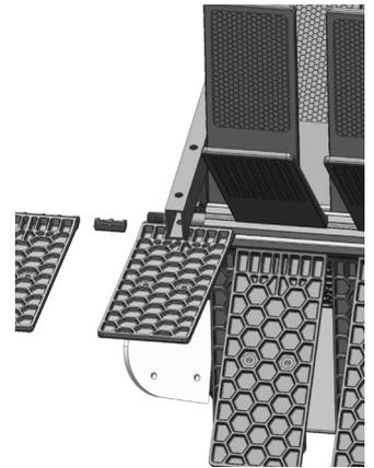
Falls Sie alle Lamellen tauschen, führen Sie dies bei einer Reihe nach der anderen aus. Sie müssen dazu die Walze immer wieder mit langsamer Drehzahl weiterdrehen, um zu allen Reihen die Zugänglichkeit zu ermöglichen.
