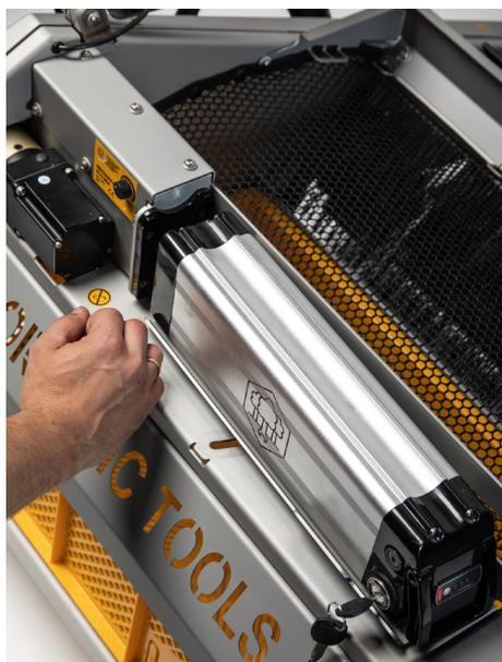
1. Zum Ausbauen des Akkus stellen Sie den Zündschlüssel auf „OFF“. Schieben Sie danach den Akku-Hebel nach rechts.
