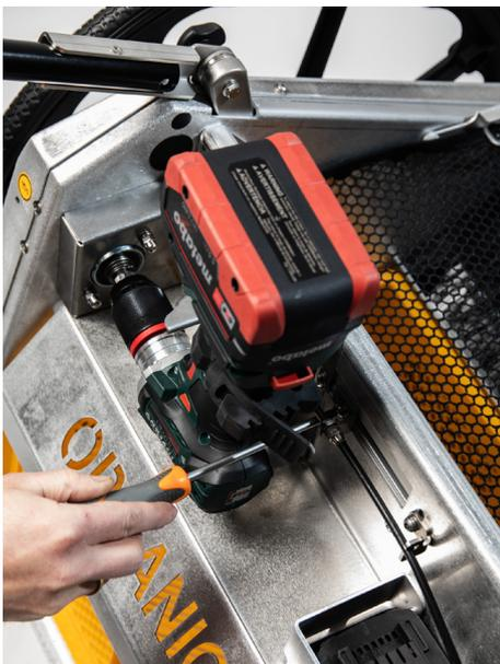
7. Um die komplette Einheit des Betätigungs-Hebels horizontal zu verschieben, öffnen Sie die Schraube wie am Foto zu sehen ist. Sie können nun den Hebel in Richtung Betätiger des Akkuschaubers verschieben. Für eine Feineinstellung steht außerdem die Justierschraube am Ende des Bowdenzuges zur Verfügung.
