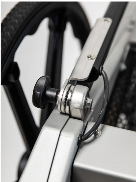
2. Fixieren Sie den Griffbügel durch anziehen der Sterngriffe. Vergewissern Sie sich, dass die Zahnscheiben vollständig und auf beiden Seiten ineinander greifen.
