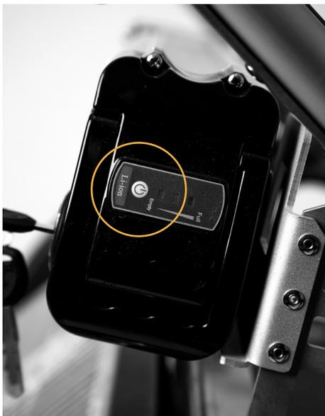
8. Zur Überprüfung des Ladezustandes drücken sie bei eingeschaltetem Akku den kleinen Knopf an der äußeren Stirnseite neben dem Zündschloss. Die erste Anzeileuchte ist immer rot, die zweite und dritte grün.
