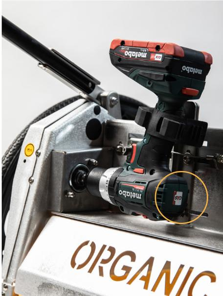
9. Am Ende muss noch der Akkuschauber mittels einer kleinen Schraube mit schwarzer Gummikappe an der Rückseite abgestützt werden. Dazu die Schraube soweit heraus drehen, bis sie am Akkuschauber ansteht.
