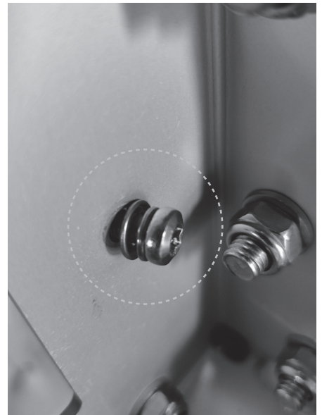
Schritt 4: Positionieren der M5 Schraube im unteren Loch der Seitenwange
