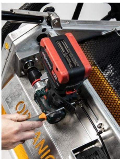
7. Pour déplacer horizontalement l'ensemble du levier d'actionnement, desserrez la vis comme indiqué sur la photo. Vous pouvez alors déplacer le levier vers l'actionneur de la visseuse sans fil. La vis de réglage située à l'extrémité du câble Bowden permet également un réglage précis.
