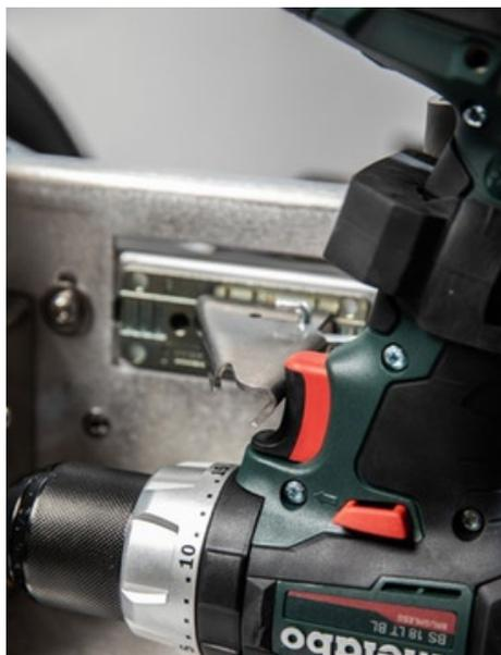
6. Il faut maintenant régler le levier de commande. Il doit être positionné approximativement au centre de l'actionneur de la visseuse sans fil.
