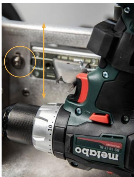
8. Pour déplacer le levier d'actionnement verticalement, la hauteur du rail entier peut être ajustée. Pour ce faire, desserrez les vis à gauche et à droite du rail, ainsi que la vis TX30 située derrière l'axe de la visseuse sans fil. L'ensemble de l'actionneur, rail compris, peut alors être réglé en hauteur afin que le levier soit centré sur l'interrupteur de la visseuse sans fil.
