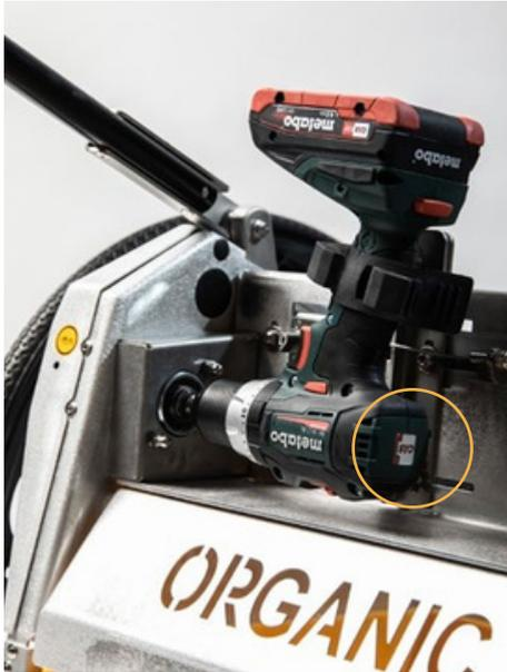
9. Enfin, la visseuse sans fil doit être maintenue à l'arrière par une petite vis munie d'un capuchon en caoutchouc noir. Pour ce faire, dévissez la vis jusqu'à ce qu'elle touche la visseuse sans fil.
