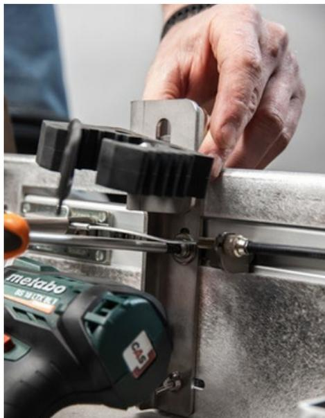
3. Ajustez la position du collier en caoutchouc qui maintient la tige de la visseuse sans fil. Pour ajuster la position latéralement, desserrez la vis TORX (TX30). Desserrez également la vis inférieure à l'arrière avec une clé ou une douille de 8 mm.
