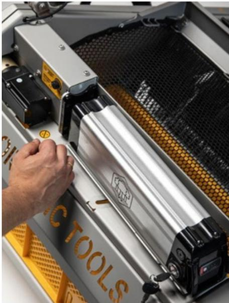
1. Pour retirer la batterie, tournez la clé de contact sur « OFF ». Faites ensuite glisser le levier de la batterie vers la droite.
