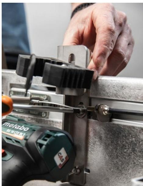
4. La hauteur de la pince en caoutchouc peut être facilement ajustée en déplaçant la pince.
