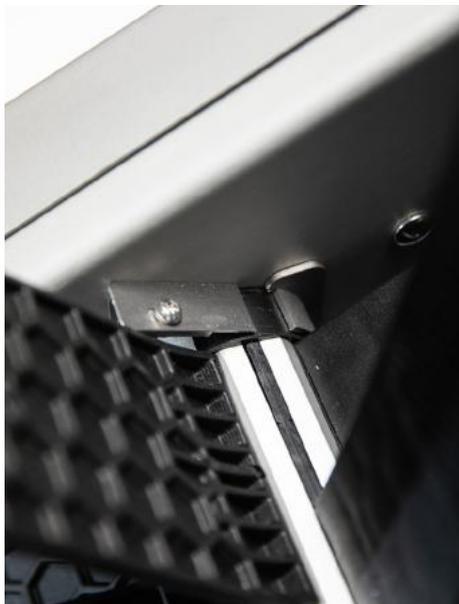
Der Graswickelschutz (13) ist auf beiden Seiten der Sammelwalze montiert und sorgt dafür, dass sich aufgrund der rotierenden Walze kein Gras in das Flanschlager wickelt. Eine kleine Klinge aus Federstahl schleift dafür über eine schwarze Kunststoffscheibe und schneidet umwickelte Grashalme ab. Die Klinge kann über ein Langloch nachjustiert werden. Kontrollieren Sie regelmäßig beide Graswickelschutze und entfernen sie etwaige umwickelte Pflanzenreste.
