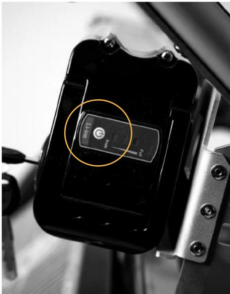
8. Zur Überprüfung des Ladezustandes drücken sie bei eingeschaltetem Akku den kleinen Knopf an der äußeren Stirnseite neben dem Zündschloss. Die erste Anzeigeleuchte ist immer rot, die zweite und dritte grün.
