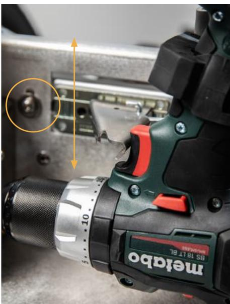
8. Für eine vertikale Verschiebung des Betätiger-Hebels kann die Höhe der kompletten Schiene verstellt werden. Öffnen Sie dazu die Schrauben links und rechts der Schiene, ebenso die Schraube TX30 hinter dem Akkuschauberschaft. Nun kann die komplette Betätiger-Einheit samt Schiene in der Höhe eingestellt werden, damit der Hebel mittig auf den Einschalter des Akkuschaubers trifft.
